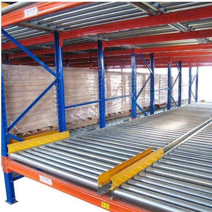
**Figura 17.** *Rack con rodillos vista frontal*
